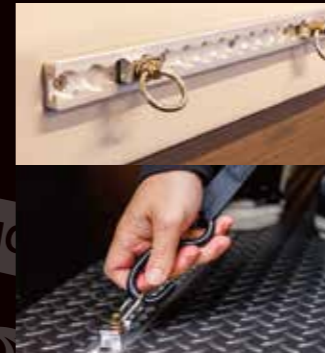
ラチェットベルトや荷締めベルト専用の固定レールもあり、大型バイクやロードバイクもしっかり固定出来ます!
